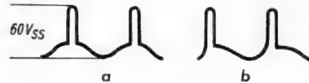
Bild 3. a = richtiger Verlauf der Spannung an der Triodenanode des Multivibrators; b = Verlauf bei dem schadhafte Empfänger
